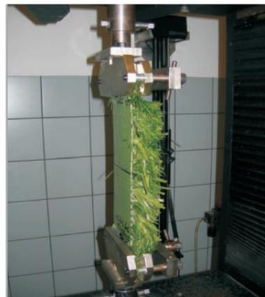
Prova di resistenza di giunzione delle superfici sintetiche realizzata con il metodo di tensione diretta in accordo alla norma europea EN 12228
